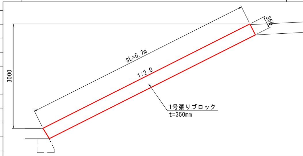
※1号張りブロックの数量は、既設護岸の法勾配が一定でないため、近似の2割勾配とし、直高=3.0m、法長=6.7mとして数量算出を行った。
